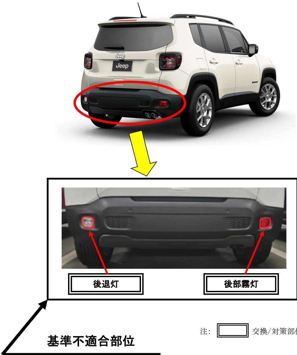
〔 リアバンパーに装着されている後退灯と後部霧灯において、製造工程での作業が不適切なため、正規仕様と異なる部品が装着されているものがある。そのため、保安基準に適合しない。 〕
